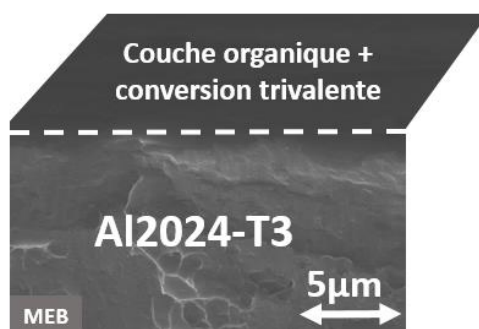
Figure 93: Image MEB en tranche de l'Al2024-T3 laminé greffé + conversion trivalente (Surtec 650)
