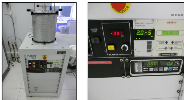
Figure C-1 : Bâti d'évaporation (à gauche) et panneau de contrôle de la machine (à droite).
