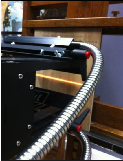
Figure II-10 - Dispositif d'illumination de la caméra hyperspectrale du C2RMF
