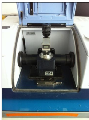
Figure II-15 - Spectromètre Bruker en mode ATR
