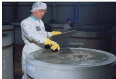
Figure 2 : Conditionnement de déchets radioactifs avec une matrice cimentaire en conteneur béton [ANDRA, 2009]
