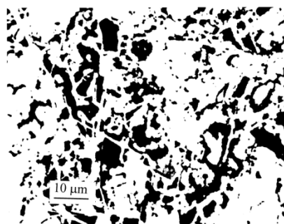
Figure 19 : Cliché MEB d'une pâte de ciment Portland âgée de 7 jours ( E/C = 0,45 ), mise en évidence du réseau poreux en noir et du matériau solide en blanc [Diamond, 2000]
