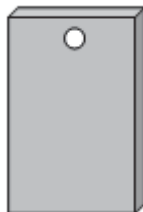
Figure A2.3.1 : Epreuve rectangulaire de surface 13,5 cm 2
