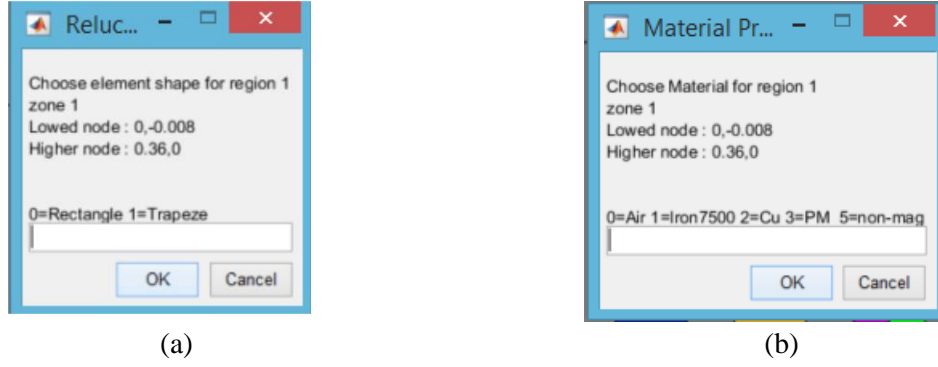
Figure 4.3. Boîtes de dialogue spécifiques. (a) forme du bloc élémentaire dans la zone. (b) matériau de la zone.
