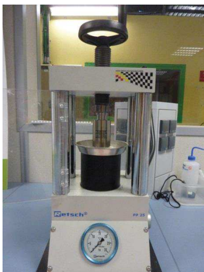
Figure 27 : Presse et module d'extraction utilisés pour l'extraction de la solution interstitielle des pâtes de ciment
