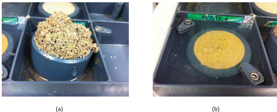
Figure 117 : Enrobé ayant servi à la mesure du temps de prise Vicat en fin d'essai ( L/C = 0,75 - n_{\text{Base}}/n_{\text{Bore}} = 0,6 - t_{\text{REI}} = 10\% - liant avec 10 % de gypse) – (a) Base = NaOH + LiOH, (b) Base = LiOH
