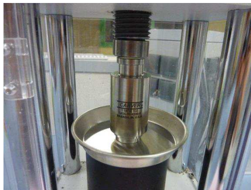
Figure 27 : Presse et module d'extraction utilisés pour l'extraction de la solution interstitielle des pâtes de ciment
