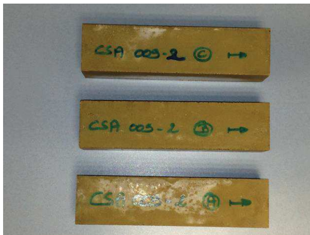
Figure 143 : Photos des éprouvettes d'enrobés de résines boratées dans un ciment sulfo-alumineux ( L/C = 0,75 – n_{Base}/n_{Bore} = 0,55 ) après 90 jours de cure sous eau
