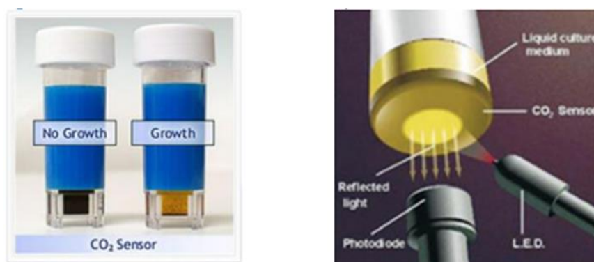
Figure 1.3-3. Flacons utilisés pour la détection du CO 2 avec le système BioLumix (à gauche) et BacT/Alert 3D (à droite). Sources : www.mybiolumix.com et www.biomerieux.fr/diagnostic-clinique/bactalertr-3d-systeme-de-detection-microbienne .
