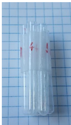
Figure 62 : Assemblage de tubes RMN pour la mesure de T_1 pour 6 concentrations différentes et l'eau
