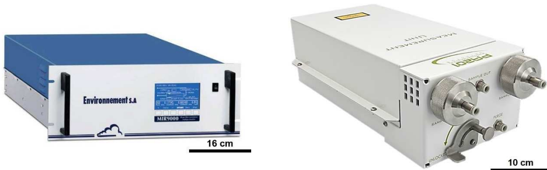
Figure I-15 : Exemple de système de mesure de gaz : a) Système NDIR avec détection dans une cellule multipassage pour la mesure de \text{NO} , \text{NO}_2 , \text{CO} , \text{HCl} , \text{HF} et \text{SO}_2 [82] b) Cellule photoacoustique de l'entreprise Gasera [83].
