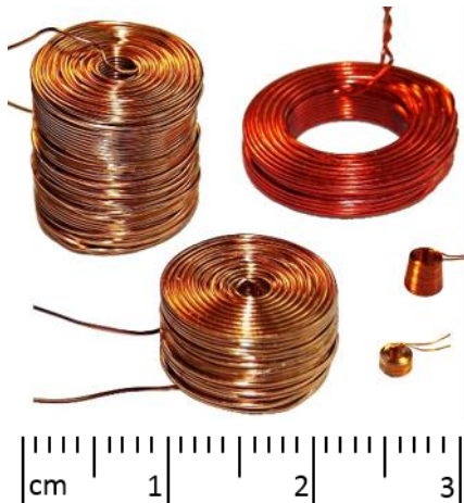
Figure 1.14 : Bobines composées d'un fil de cuivre enroulé autour d'un noyau d'air
