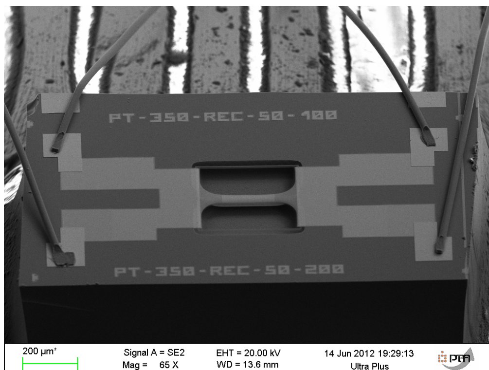
Figure 93. Image MEB d'un dispositif REC 50-200 avec des connections électriques réalisées par microsoudure.
