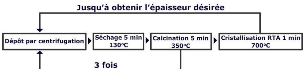
Figure 62. Schéma du procédé sol-gel pour le dépôt PZT.
