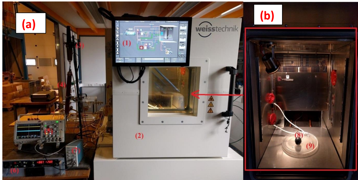
Figure II.19 : photographie du dispositif expérimental permettant l'étude dans diverses conditions environnementales : 1-écran de contrôle 2-enceinte climatique 3- sonde de tension 4- résistance de protection 5- oscilloscope 6-Générateur 7- boîtier Sonde de courant (b) zoom sur l'intérieur de l'enceinte climatique : 8- connecteur étudié 9-plateau en pyrex isolant.
