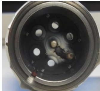
Figure IV.40 : photographie de la face avant d'une fiche mâle après vieillissement de type 2.
