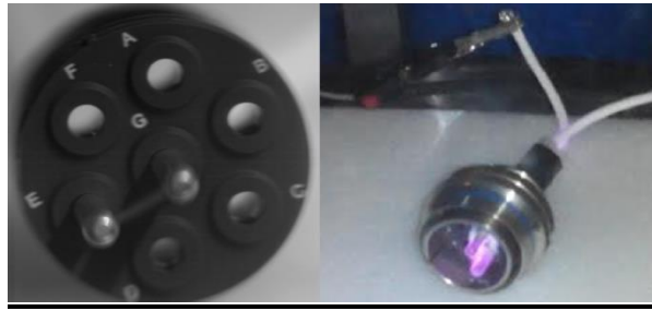
Figure IV.14 : photographie de décharges dans l'air en surface entre 2 électrodes de contact d'une fiche mâle.
