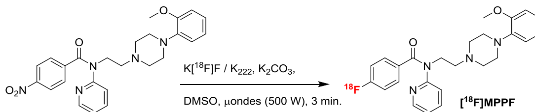
Schéma 5 : Radiosynthèse du [ 18 F]MPPF par substitution nucléophile aromatique.
