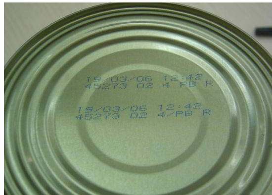
Figure 8.22 - Marquage par jet d'encre sur une boîte de conserve
