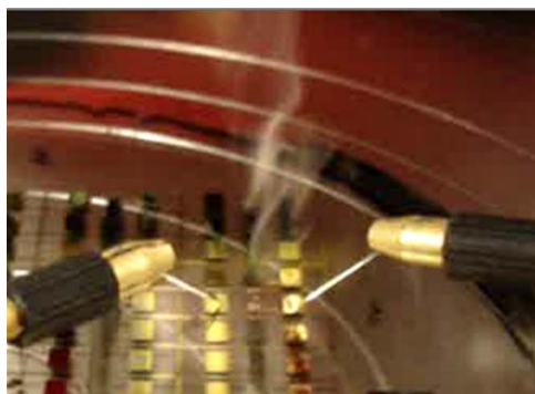
Figure 71. Initiation de la nanothermite sous forme de multicouches : dégagement de fumée
