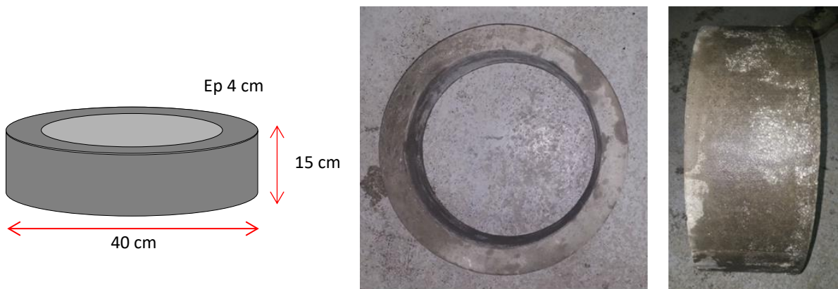
Figure III-4 : géométries et photos des anneaux de béton au démoulage
