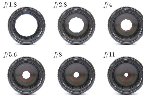
FIGURE II.5 – Objectifs ayant différentes ouvertures (credit : KoeppiK).
