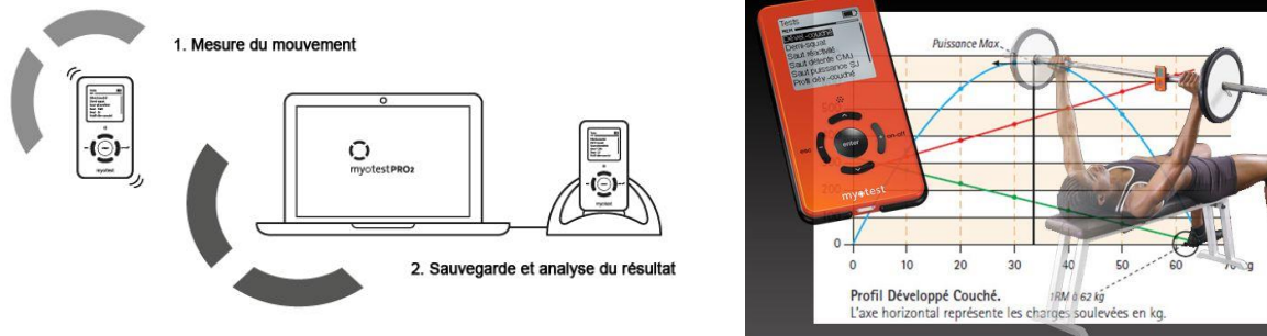
Figure 11. Schéma de fonctionnement d'un accéléromètre (Myotest®, Suisse) lors du développé-couché ( https://www.myotest.com/ )
