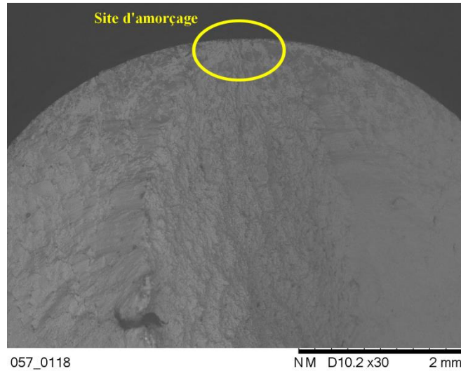
Figure IV. 8 : Faciès de rupture d'une éprouvette brute d'usinage testée en traction-torsion combinées : \sigma^{alt}=150 MPa, \tau^{alt}=70 MPa, \varphi=0^\circ , R_\sigma=-1 et R_\tau=0.1
