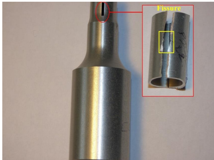
Figure III. 44 : Fissuration des éprouvettes testées en pression interne pure à l'état colmaté
