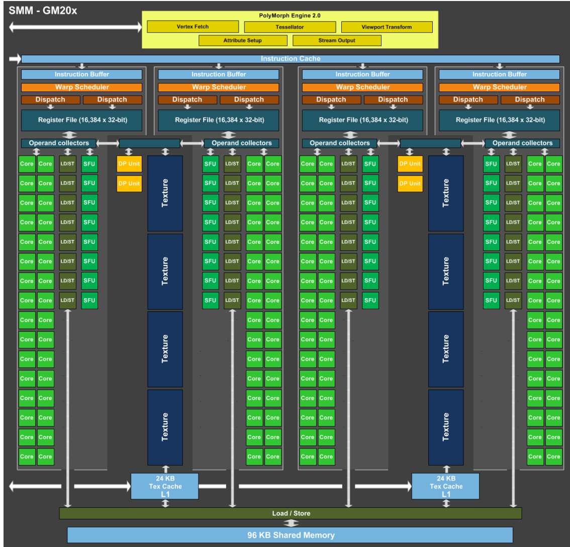
FIGURE 4.2 – Vue d'un cluster SMM de l'architecture Nvidia Maxwell de seconde génération utilisée pour la Tegra X1
