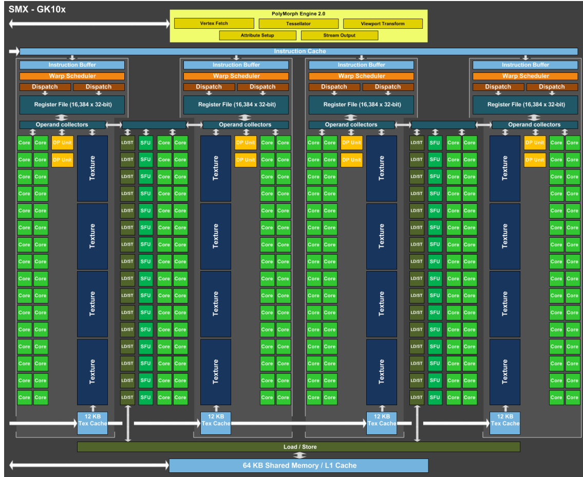
FIGURE 4.1 – Vue d’un cluster SMX de l’architecture Nvidia Kepler de première génération utilisée pour les Quadro K2000
