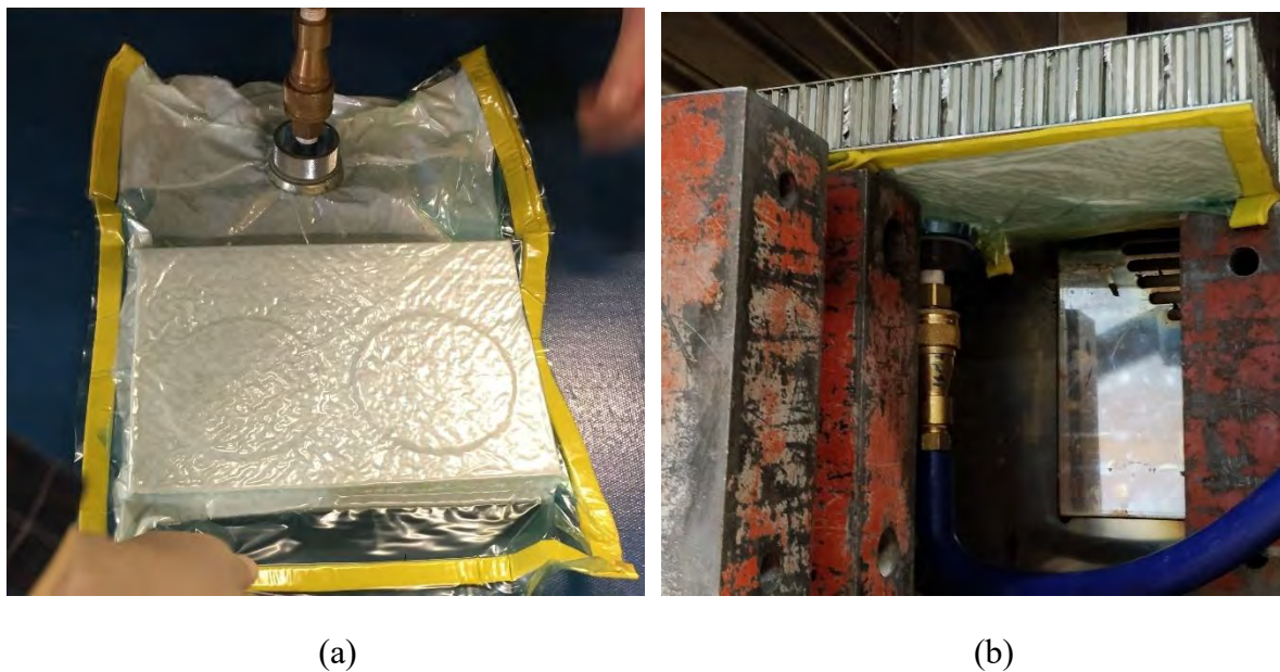
Figure 2.37 – Préparation et polymérisation de la structure sandwich : (a) application du vide, (b) emplacement dans le four.
