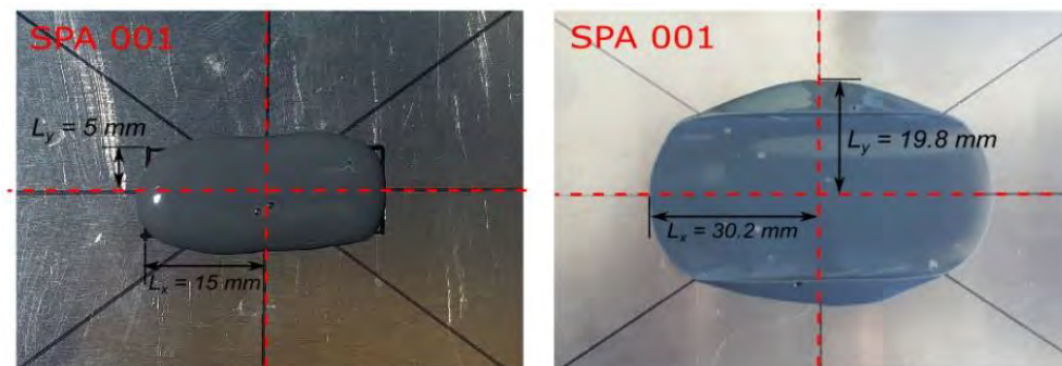
Figure 2.21– Répartition de l'adhésif avant essai et après la polymérisation pour l'essai SPA001.
