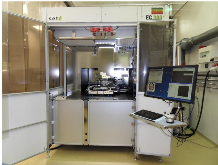
Fig. 3.7. Photographie de l'équipement FC300 de pose des filtres colorés avec le moniteur de commande.
