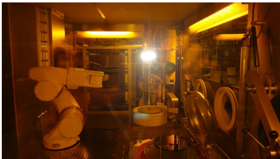
Fig. 3.5. Photographie de la boîte à gant reliée au cluster par la chambre buffer (sur le côté gauche de la photo). Le bras robotisé sert à transférer ces wafers entrant dans la boîte à gants vers l'ALD (situé au fond à droite) et si nécessaire vers la tournette (située au premier plan à droite).
