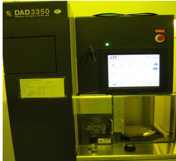
Fig. 3.10. Photographie de l'équipement de découpe DAD3350.
