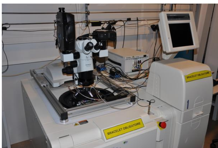
Fig. 3.22. Photographie du banc de test prober servant à qualifier les futurs microdisplays OLED.
