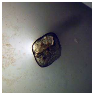
Figure 4.49 – Cristal de HEWL co-cristallisé en présence de 2,7 mM de [\text{Eu}(\text{CTDPA})_3]^{3-}
