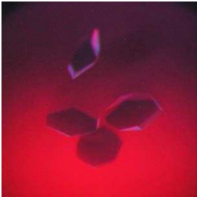
(b) Cristaux dérivés de HEWL (10 mg.mL -1 t 0 ) avec 10 mM t 0 Eu(HMTDPA) 3 , UV proches
