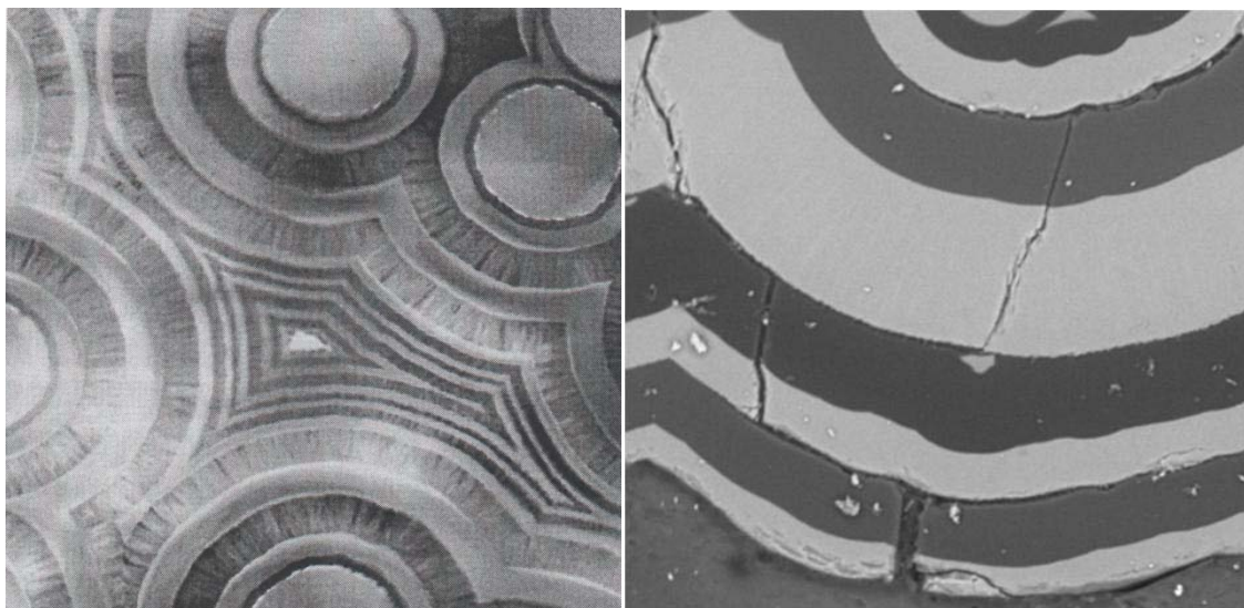
Figure IV-7. Exemple de composite à matrice auto-cicatrisante séquencée (MET fond clair, x2350) [Bourrat, 2005] et exemple de multidéviation de fissures dans la matrice séquencée après essais de traction monotone à température ambiante. Les couches de SiC apparaissent en gris clair et les couches borées en gris foncé [Herbreteau, 2011]
