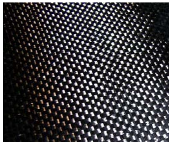
Préforme fibreuse, Tissage 2D avant densification
