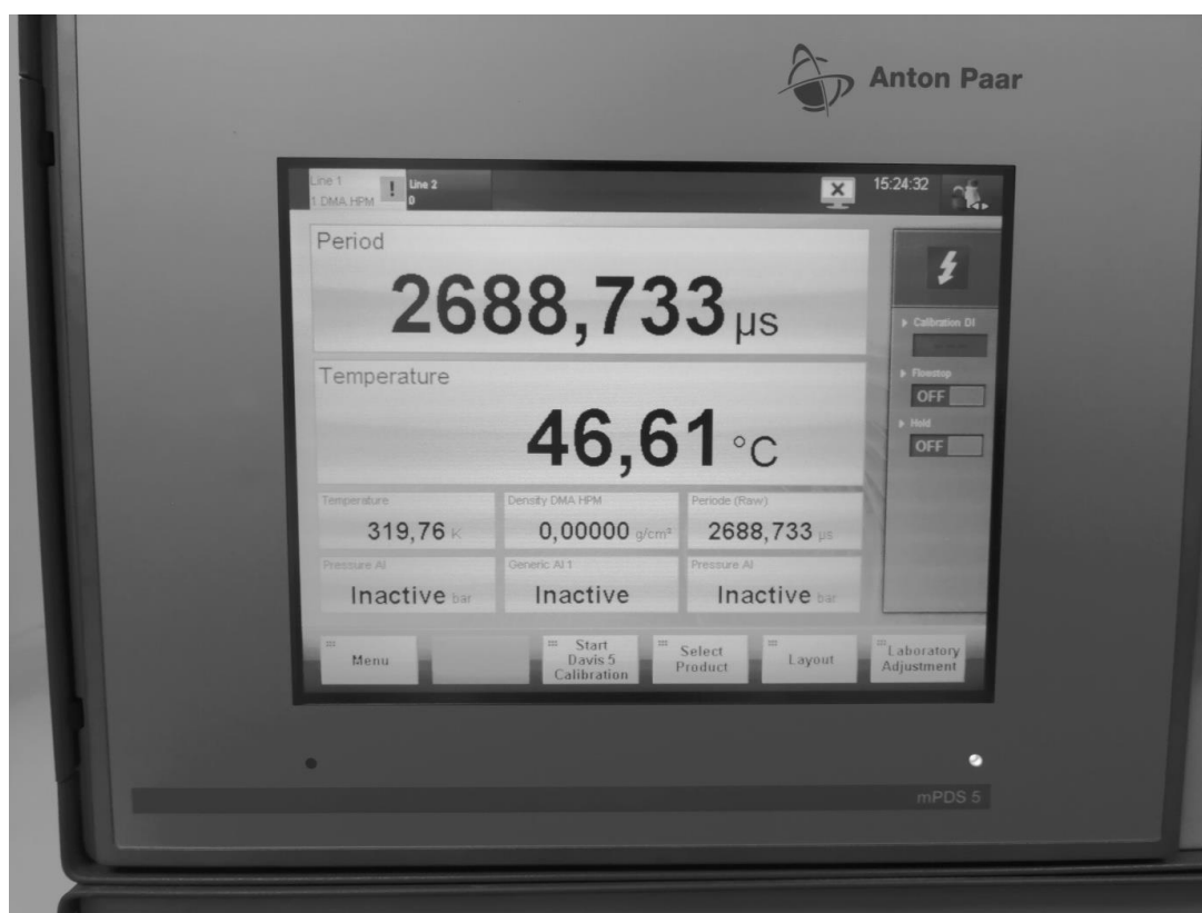
Figure II. 12 : Affichage de l'unité d'acquisition mPDS 5, Anton Paar. De haut en bas : lecture de la période de vibration, lecture de la température interne du densimètre.
