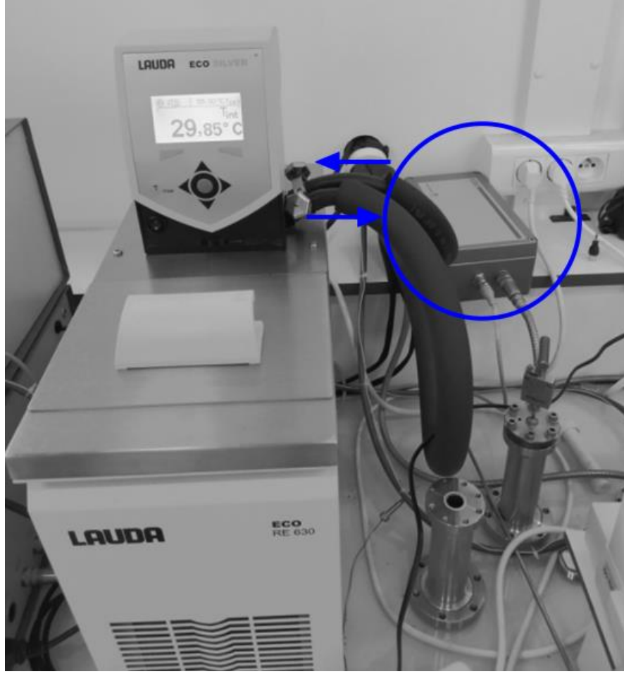
Figure II. 13 : Bain liquide Lauda ECO RE630. Flèches : entrée et sortie du bain alimentant le densimètre à tube vibrant, cercle : unité d'acquisition branchée entre le densimètre à tube vibrant et l'afficheur mPDS 5.
