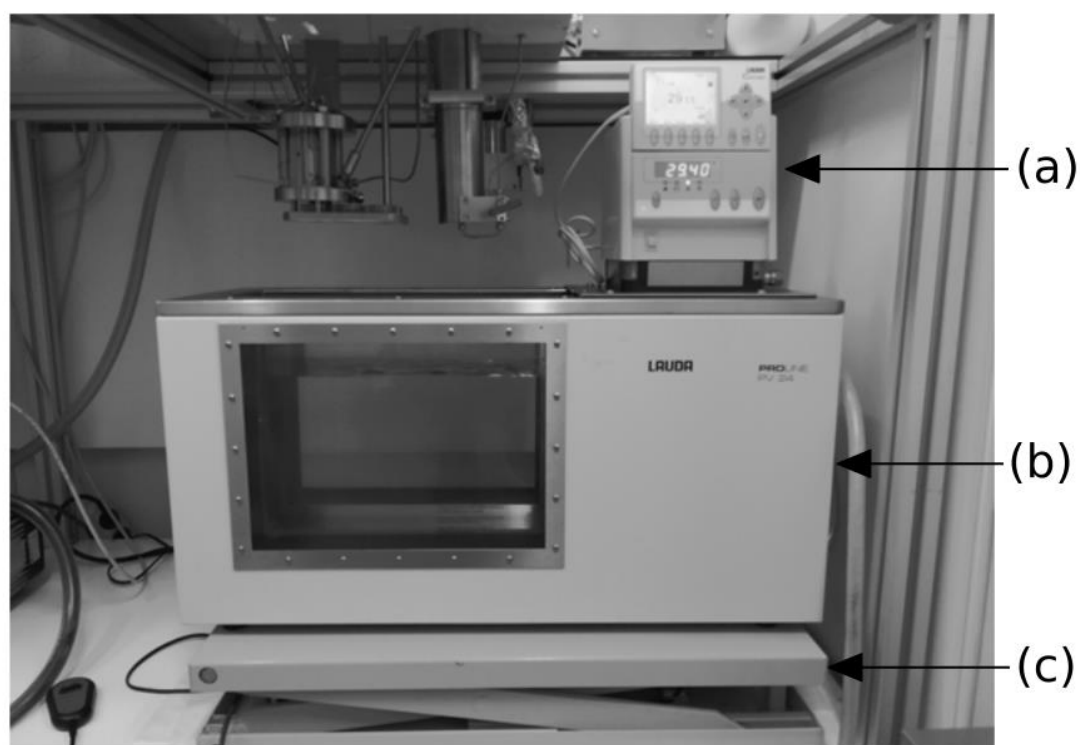
Figure II. 9 : Bain liquide. (a) : thermostat du bain, (b) : bain liquide, (c) : élévateur électrique.
