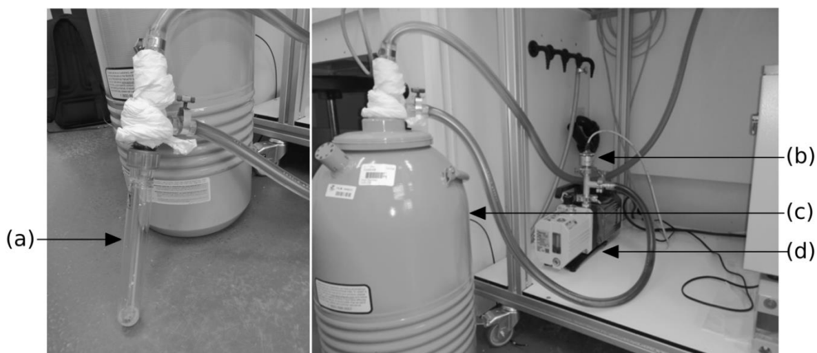
Figure II. 8 : Système de tirage sous vide. (a) : piège à vide, (b) : capteur de pression de la pompe à vide, (c) : dewar rempli d'azote liquide, (d) : pompe à vide.
