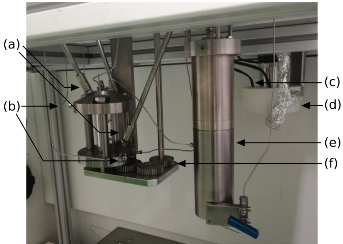
Figure II. 4 : Dispositif expérimental, première partie. (a) : vannes de chargement, (b) : lignes de chargement, (c) : cartouches chauffantes, (d) : pompe centrifuge, (e) : viscosimètre à lame vibrante, (f) : entraînement de l'agitateur magnétique.
