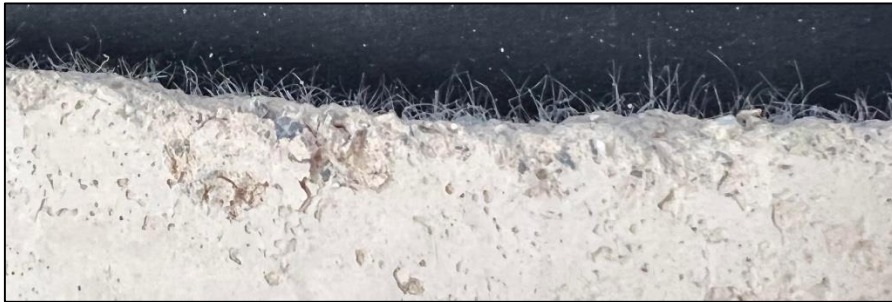
Figure V-12: Dispersion des fibres de polypropylènes
