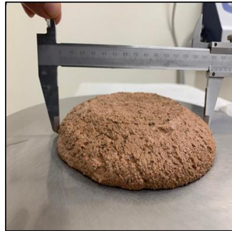
Figure II-20: Essai à la table à secousses
