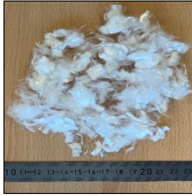
Figure II-1: Les fibres polypropylènes
