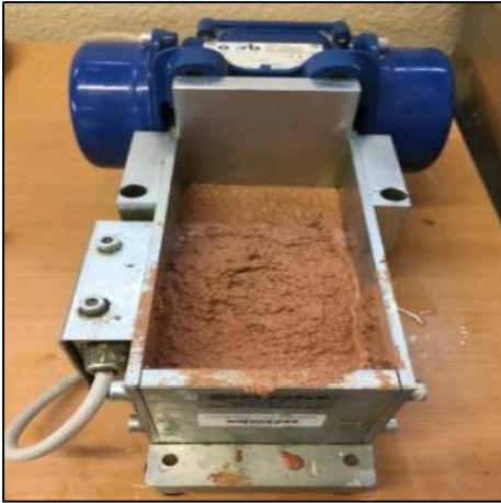
Figure II-19: Essai au maniabilimètre
