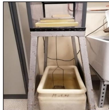
Figure II-26: Système de pesée hydrostatique
