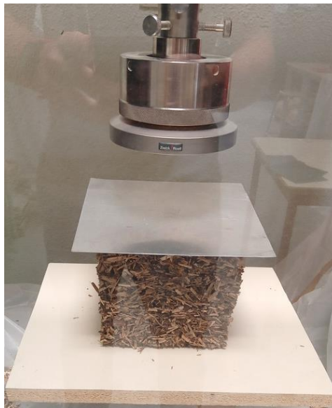
Figure 2.29. Eprouvette faite des granulats seuls prête pour l'essai de compression.
