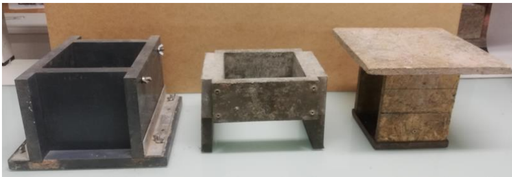
Figure 2.15. Moule cubique 15 \times 15 \times 15 \text{ cm}^3 (gauche), rehausse de 7,5 cm (milieu) et piston (droite) utilisés pour la détermination de la masse volumique compactée à l'état humide puis séchée et la fabrication des futurs blocs de bétons végétaux.
