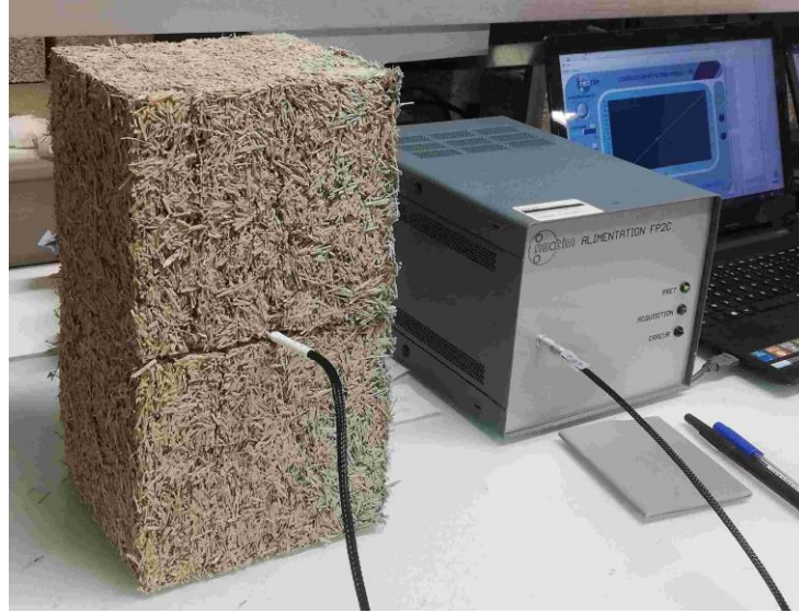
Figure 3.4. Mesure de la conductivité thermique entre deux éprouvettes de 15 \times 15 \times 15 \text{ cm}^3 .
