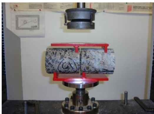
Figure II-23 Appareillage de l'essai de cisaillement [Souza et al., 2019]
