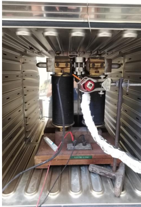
Figure 70. Photo du dispositif expérimental pour la mesure de solubilité de l'oxygène dans un ferrofluide utilisant un électroaimant puissant.
