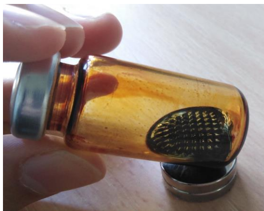
Figure 66. Photo d'un ferrofluide synthétisé au laboratoire
