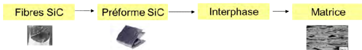
Figure I. 5 : Grandes étapes de l'élaboration d'un CMC.
