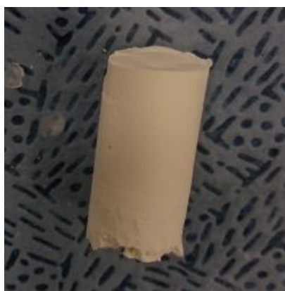
Figure 155. Gâteau de filtration de 3 cm de hauteur obtenu par remplissage complet de la membrane inox, lors du passage d'une suspension de BioUltra à 6‰
