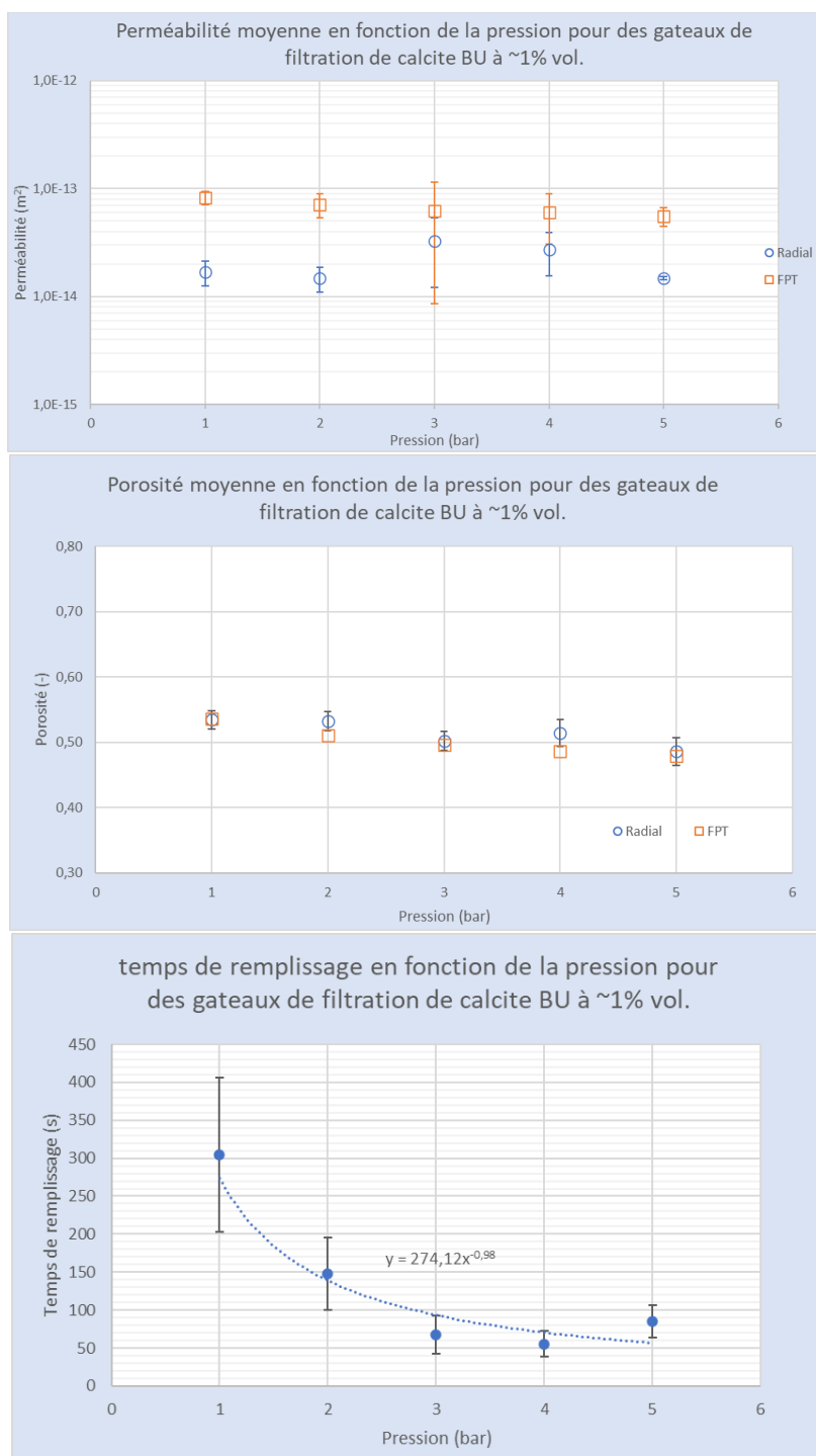
Figure 138. Evolution de la perméabilité, de la porosité mesurées dans la cellule radiale et la cellule miniaturisée FPT, et du temps de remplissage en fonction de la pression, mesurés dans la cellule radiale, pour une suspension diluée de calcite BU
