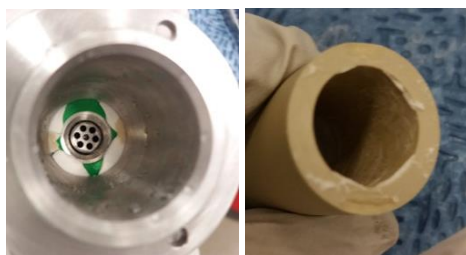
Figure 154 A) Vu de l'intérieur de la deuxième cellule conçue avec des morceaux de la membrane de \text{TiO}_2 B) Membrane en \text{TiO}_2 présentant des éclats après utilisation
