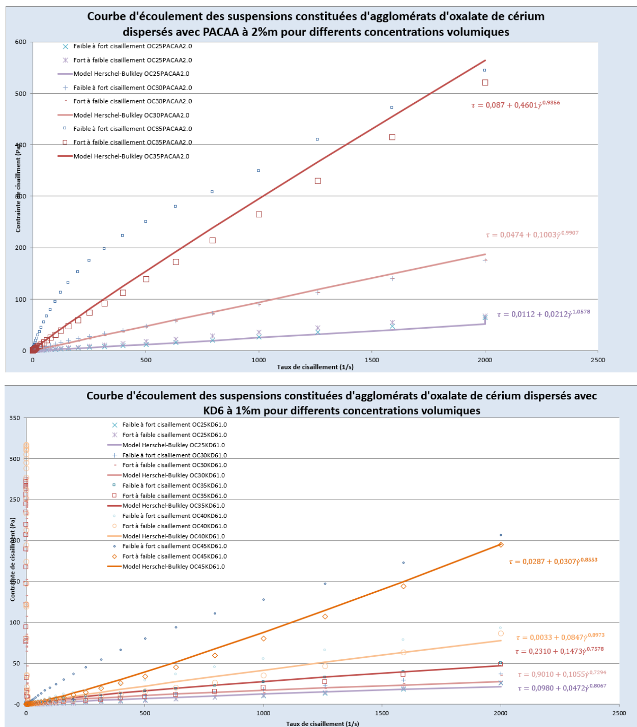
Figure 147. Courbes d'écoulement pour deux suspensions d'oxalate de cérium, dispersées avec PACAA et avec KD6. La première est à 25, 30, 35 %vol et la deuxième à 25,30,35,40 et 45 %vol.
