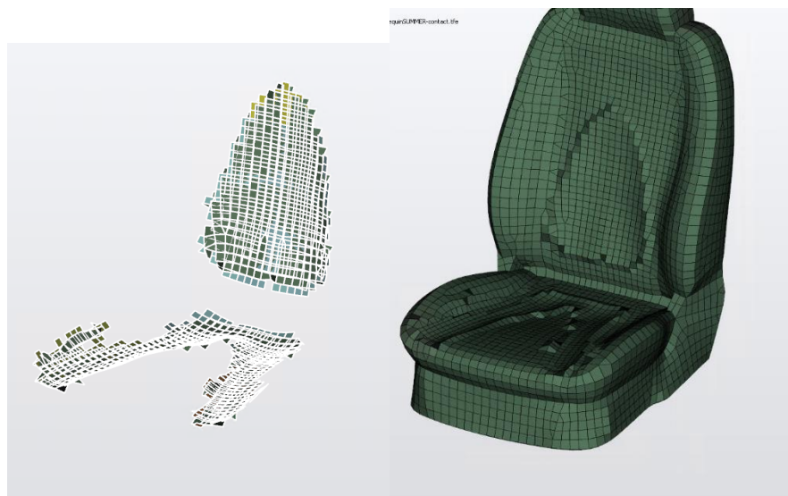
Figure 97 Zone de contact (gauche) et déformation du siège (droite)
