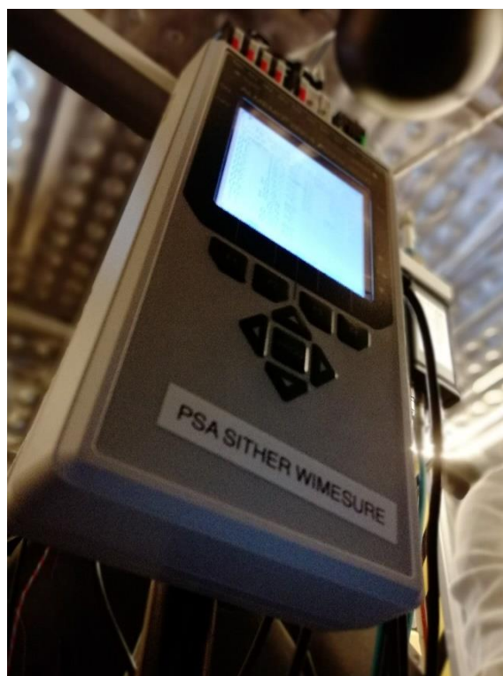
Figure 80 – Unité d'acquisition des données WiMeasure
