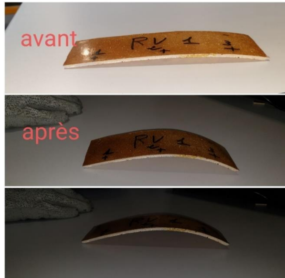
Fig 5- 32 : Plaque en résine avant et après son laminage à 100°C
