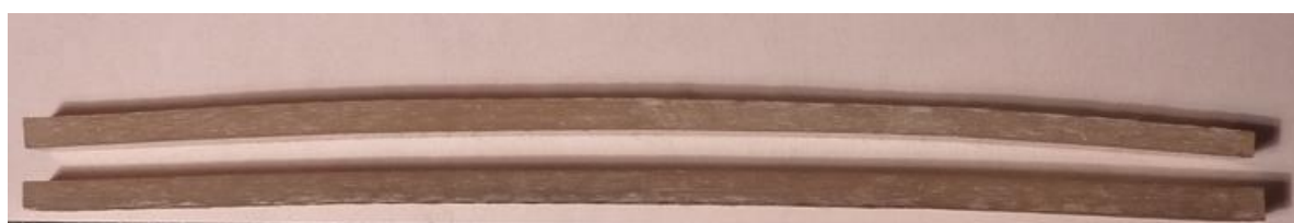
Fig 5- 27 : Epreuves en composite après flexion 4 points sous charge à 90°C
