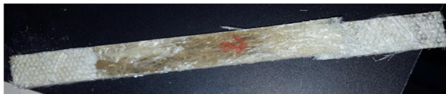
Fig 2- 13 : Image des échantillons du LU1 après leur traction à 120°C et à 150°C
