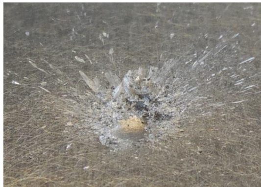
Figure III-31 : Face avant, quasiment intacte, de la plaque arrière d'une protection tricouche AA6-air10-AA6 impactée par un projectile D6.35-WC-Plat à 428 m/s avec le lanceur Ø60
