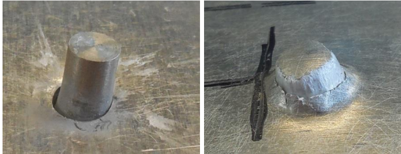
Figure III-30 : Face avant (gauche) et arrière (droite) de la plaque arrière d'une protection tricouche AA6-air10-AA6 impactée par un projectile D6.35-Acier-Plat à 632 m/s avec le lanceur Ø60
