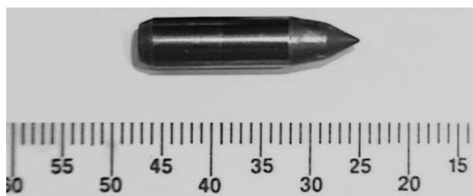
Figure II-7 : Cœur en carbure de tungstène d'une balle 7,62×51 Sniper 9 [Hazell et al., 2008]
