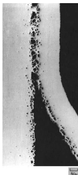
Figure II-10 : Exemple d'écaillage dans une plaque en alliage d'aluminium [Barbee et al., 1970]
