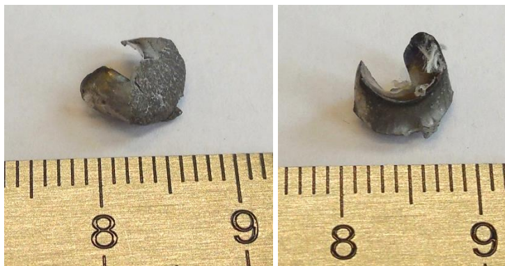
Figure III-28 : Matière éjectée par le passage d'un projectile D6.35-WC-Conique à 714 m/s à travers une protection MS8.8 avec le lanceur Ø60. Gauche : Face arrière. Droite : Face avant / profil.
