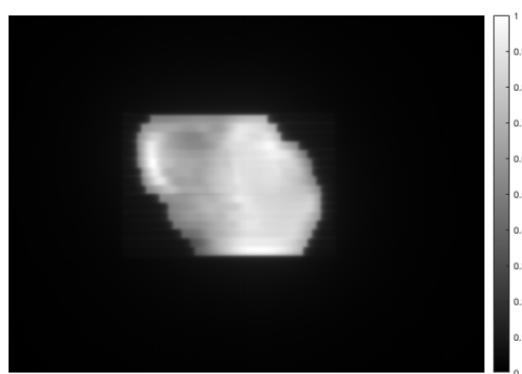
FIGURE 4.19 – Image EPID pour la RCMI 25 MeV Varian® à partir d'un RNA classique
