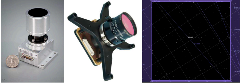
FIGURE 4.1 – Capteurs optiques envisageables : Viseur d'étoiles Auriga de Sodern (France), imageur C1U de GomSpace (Pays-Bas), à droite simulation de champ de vue ( 5^\circ \times 5^\circ ) avec objet d'avant-plan.
