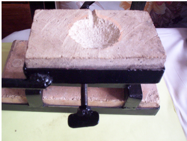
Figure 19 : Le creuset en matériau réfractaire
