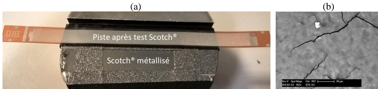
Fig. 2.35 : (a) Photographie de la préparation d'échantillons du test Scotch® avant observation au MEB, avec la piste après le test Scotch®, et la bande adhésive métallisée ; (b) Image MEB-BSE d'une bande adhésive métallisée, avec la présence de craquelures.
