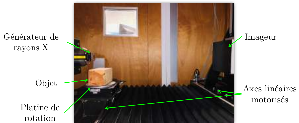
Figure A.2 – Principaux composants du MICRO-TOMOGRAPHE EASYTOM 130
