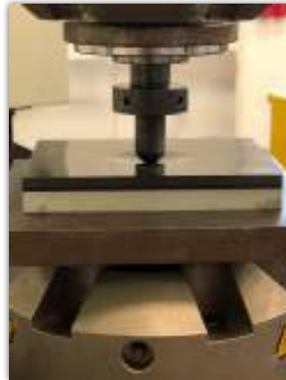
Figure IV.37 – Déformation locale du 13P 0-90 en cours d’indentation
