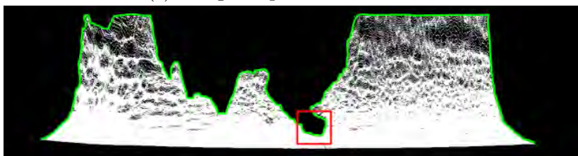
(d) Exemple de carte polaire - Ligne verte : Bordure du nuage de points
