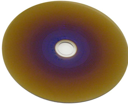
(a) Photographie d'un disque à Super-Résolution au format Blu-Ray, de diamètre 12 cm. Les zones d'études sont concentrées entre les rayons 22 mm et 30 mm.
