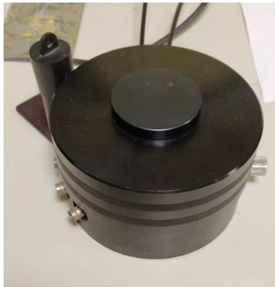
Figure 56 : Enceinte thermique fermée lors de la mesure C-DLTS
