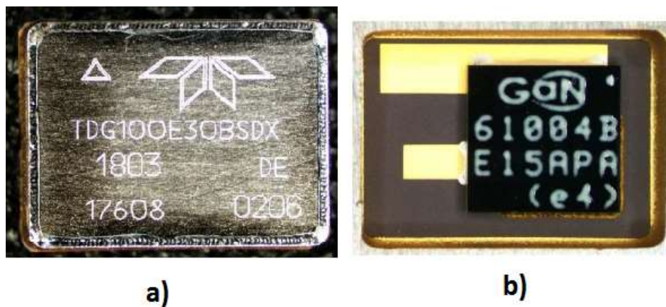
Figure 115 : Composant Radiationref_5, (a) vue externe (b) et boîtier ouvert
