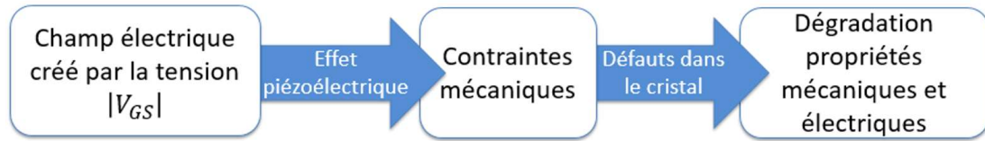
Figure 34 : Schéma de l'effet piézoélectrique inverse
