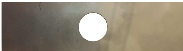
Figure 7.4 – Photographie de l'éprouvette d'acier « 316L » utilisée.
