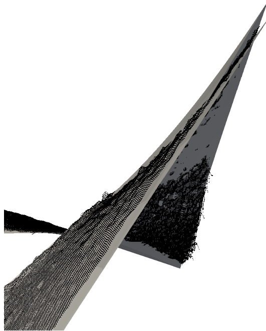
Figure 6.8 – Influence de la régularisation géométrique, pour plusieurs échelles, sur la forme mesurée (surface grise) et comparée à une mesure avec une méthode locale (nuage de points noirs). Amplification \times 30 .
