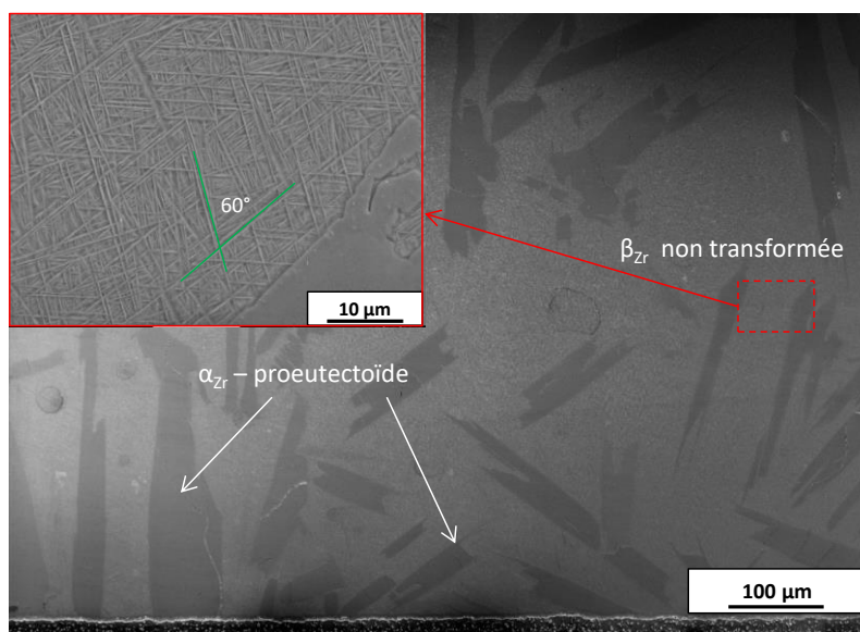
Figure III.21 : Microstructure observée au MEB en mode électrons secondaires (SE) d'une gaine en Zy4 préhydrurée à 950 ppm-mass. et chargée en oxygène à 0,57 %-mass. d'après le gain de masse, à l'issue d'une trempe directe après traitement thermique à 1300°C pendant 4h
