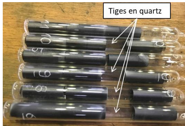
Figure III.12 : Capsules en quartz contenant des tronçons de tube en Zy4 et en M5 Framatome préhydrurés et oxydés et des tiges de quartz placées à l'intérieur des tubes avant traitement thermique d'homogénéisation
