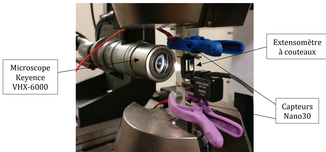
Figure II-15 – Dispositif des essais de traction avec suivi microscopique
