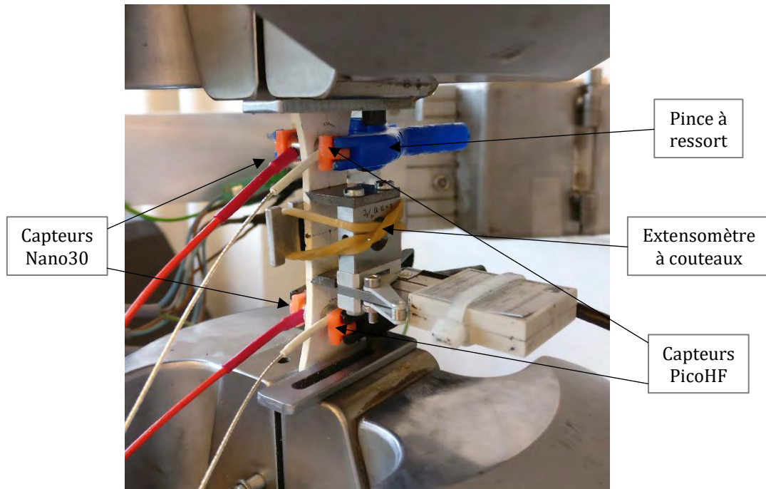
Figure II-14 – Instrumentation réalisée en configuration standard lors des essais à l'échelle macroscopique
