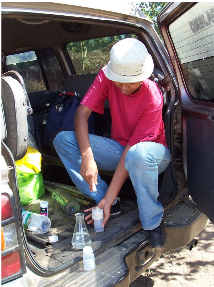
Photographie 5. Filtrage sur terrain des échantillons d'eau pour les analyses chimiques
