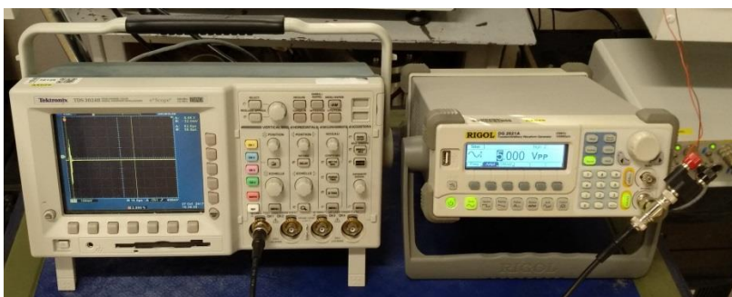
Générateur et acquisition de l'onde ultrasonore pour la mesure du déplacement axial
