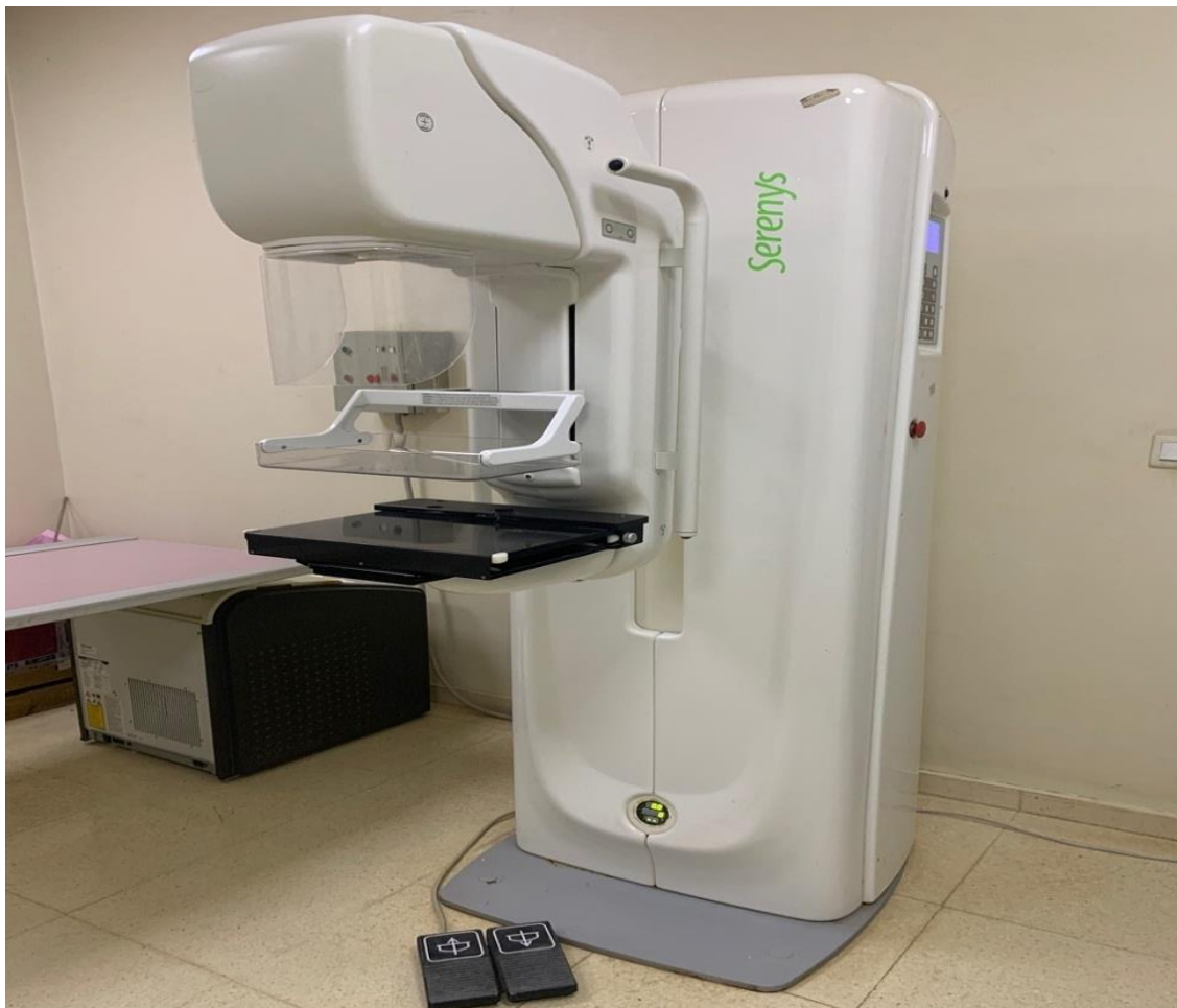
Figure 5 : Mammographe avec système de compression motorisé, et commande au pied permettant de comprimer le sein.
