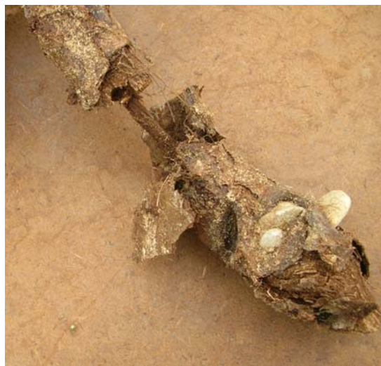
Figure III.Ch3.3 : Différence de résistance à la dégradation du bois entre les parties interne, périphérique et l'écorce
