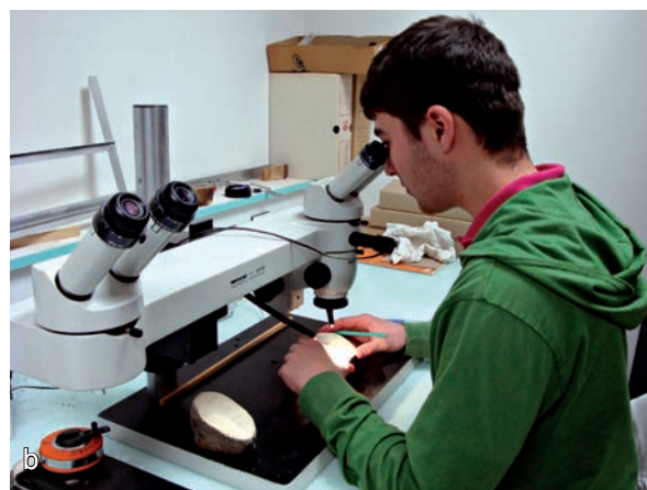
Figure 6 - Travaux au laboratoire : a) ponçage des échantillons ; b) lecture de cernes sous loupe binoculaire.
